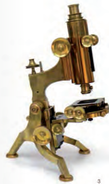
3. WATSON & SONS, Microscope Van Heurck Grand modèle, Londres, fin 19 e -début 20 e s. Laiton et verre. 37 x 28 x 25 cm. N° inv. D253. UCL - Dépôt de la donation P. A. Roussou. Ce microscope porte le nom de Henri Ferdinand Van Heurck (1838-1909), industriel belge, botaniste, distillateur et collectionneur de renoms. Plus connu à l'étranger qu'en Belgique, ce spécialiste en microscopie et en microtechnique a travaillé entre autres avec Watson pour mettre au point des microscopes performants.
